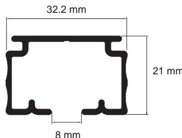
**Descriptif > Rail aluminium anodisé 32x21mm**
